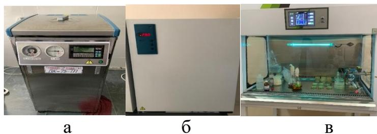
Рисунок 1 – Оборудование для микробиологического исследования (а) автоклав; б) термостат; в) ламинарный бокс).
