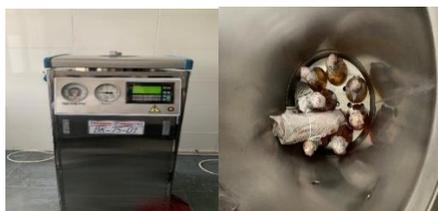
Рисунок 3 – Стерилизация питательной среды в автоклаве
