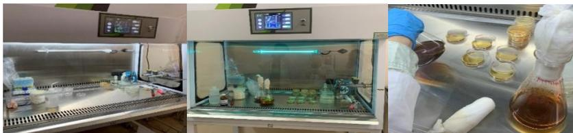
Рисунок 7 – Разлив питательной среды в ламинарном боксе
